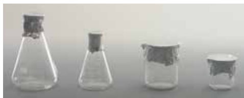
図a ガラス器具の乾熱滅菌
